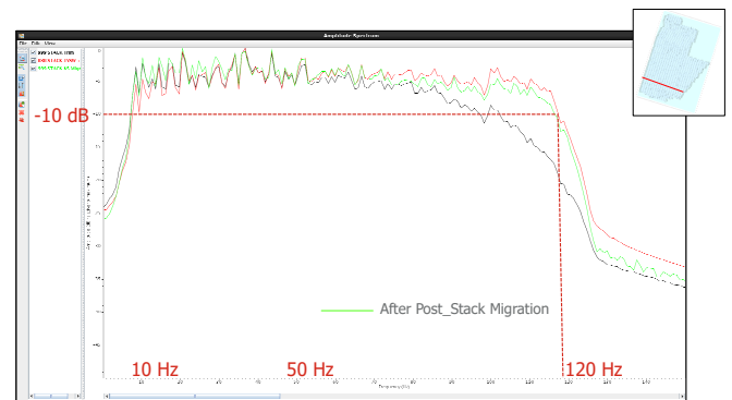
Figura 8: Ejemplo del contenido de frecuencia en una inline del proyecto. La línea de color verde muestra los resultados luego de aplicar la migración post-apilado. Se recuperan frecuencias superiores a los 100 hz.
