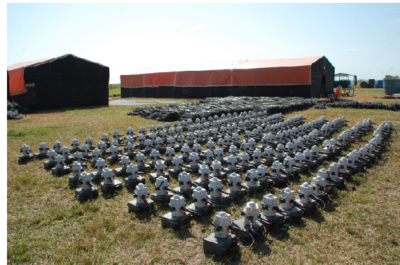
Figura 5: Unidades de adquisición remota RAU eX-3 ® .
