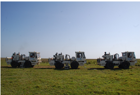
Figura 4: Mini-Vibrators durante las operaciones de registro.
