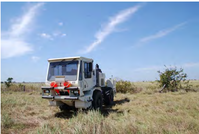
Figura 9. “Mini Vibrators” IONOVA UNIVIB PLS 326®. Dimensiones: 3 metros de alto, 1,92 de ancho y 6,32 metros de largo. “Peak Force” de 26.000 libras.
